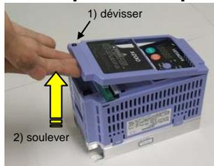
Le dépôt du capot principal du X200 est différente comparée aux modèles L100, L200 précédents. **Dévisser** d'abord la vis en bas à gauche du capot. Puis **soulever** le capot depuis le bas comme indiqué sur la photo ci contre.
